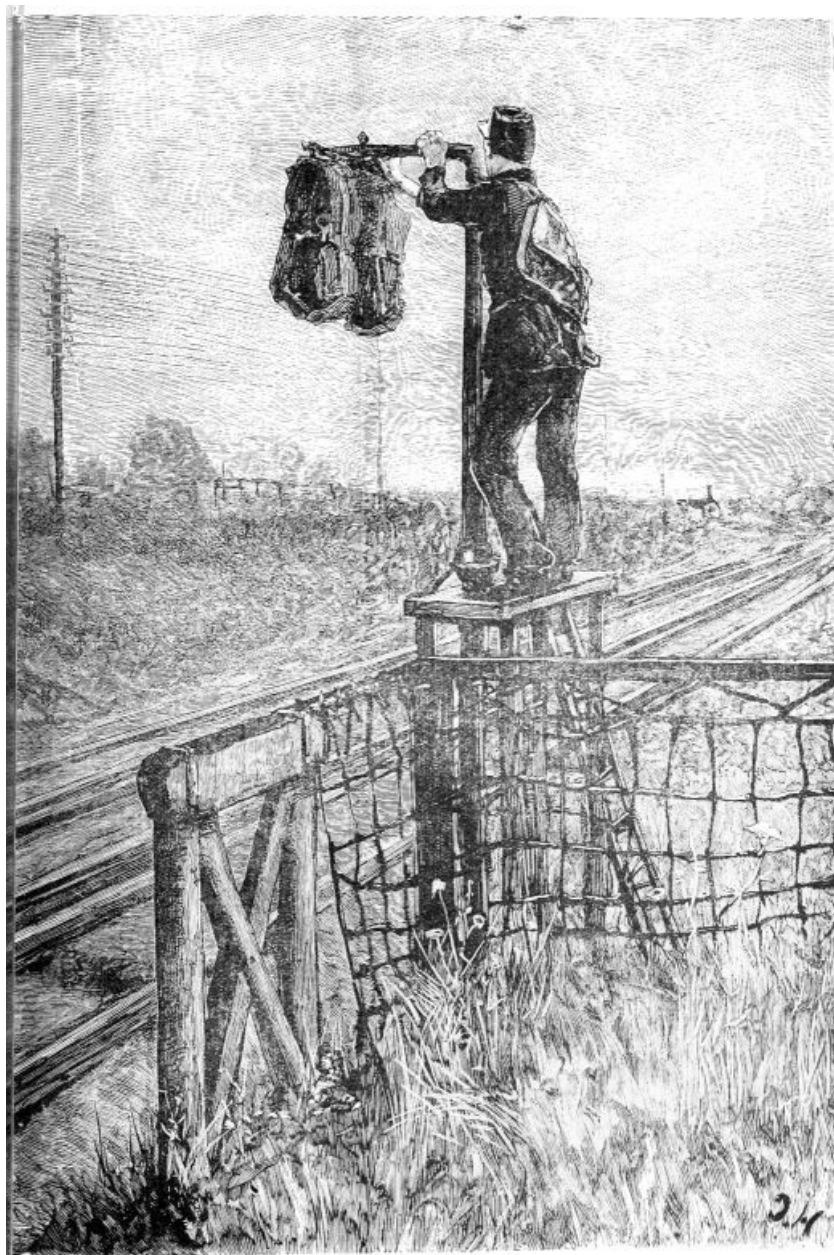
Appareil pour la remise des dépêches aux trains en marche.
