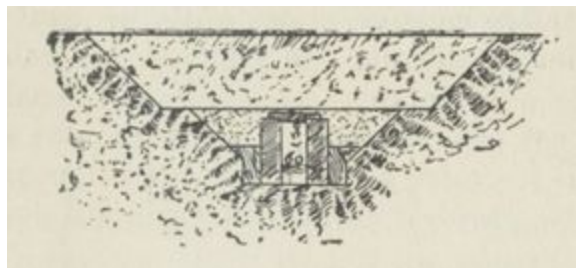
Fig 95 . — Galerie filtrante de Toulouse.
