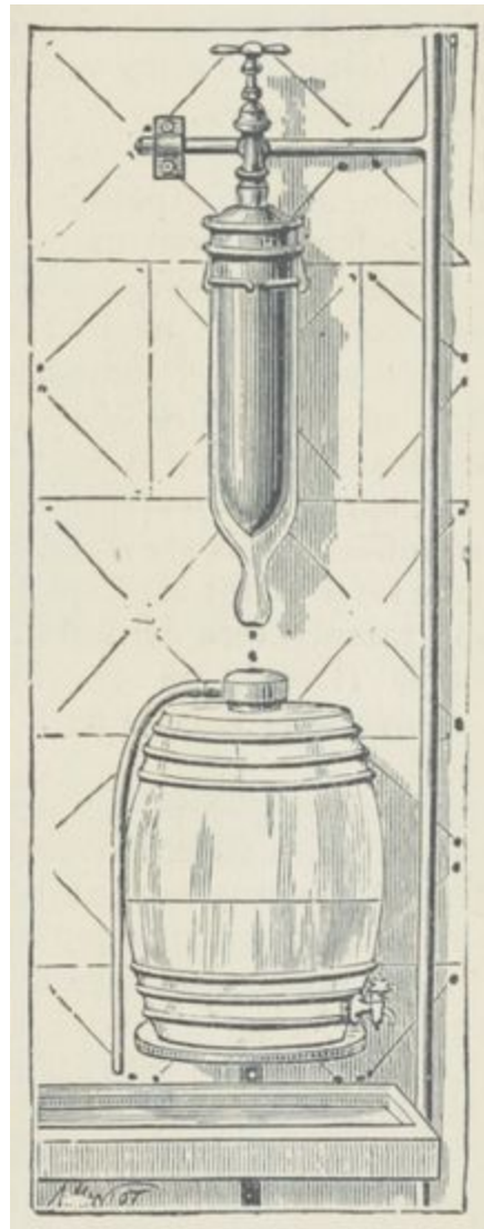
Fig. 110. — Aérifiltre Mallié (vue extérieure).
