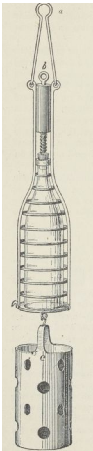
Fig. 4. — Appareil destiné à puiser l'eau pour l'analyse chimique.
