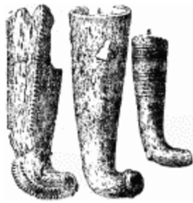
Fig. 65.—Tuyères de fours métallurgiques.—1, Silésie.—2-3, Hongrie. (agrandir)
