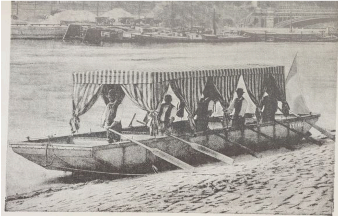
FIG. 54. — Chaloupe construite en aluminium. (Figure communiquée par le Génie civil. )
