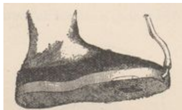
Fig. 86. — Chaussure exploratrice destinée à signaler la pression du pied sur le sol.
