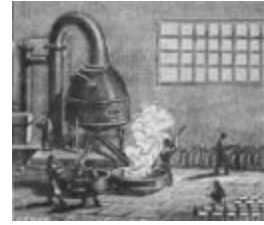
UNE RAFFINERIE DE SUCRE A NANTES.—Le sucre se fait, comme on sait, avec le jus de la canne à sucre ou celui de la betterave, qu'on fait bouillir dans une chaudière. Le sucre, clarifié et raffiné dans le grand appareil représenté à gauche, tombe bouillant dans des réservoirs. On le verse ensuite dans des moules et on l'y laisse refroidir. Ainsi se forment ces pains de sucre que l'ouvrier de droite tire des moules.
