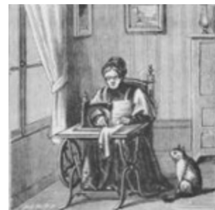
LA MACHINE A COUDRE.—Cette machine, si utile et si répandue aujourd'hui, a été inventée il n'y a pas longtemps par l'Américain Elias Howe. On la meut la plupart du temps avec le pied. Elle coud avec rapidité et solidité. Une machine à
