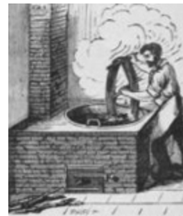
LA TEINTURERIE.—Pour teindre les écheveaux de laine, de coton, de soie, le teinturier les trempe dans un bain colorant, en les tournant et retournant sur des bâtons.
