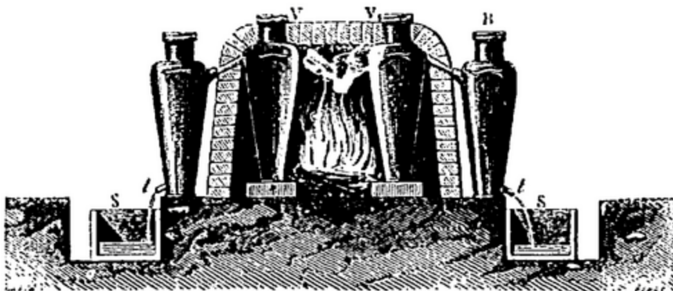
Fig. 43. — Extraction du soufre par distillation. — V, vases dans lesquels on place le minéral de soufre ; B, vases dans lesquels se condense le soufre ; S, vase dans lequel s'écoule par la tubulure t le soufre fondu.
