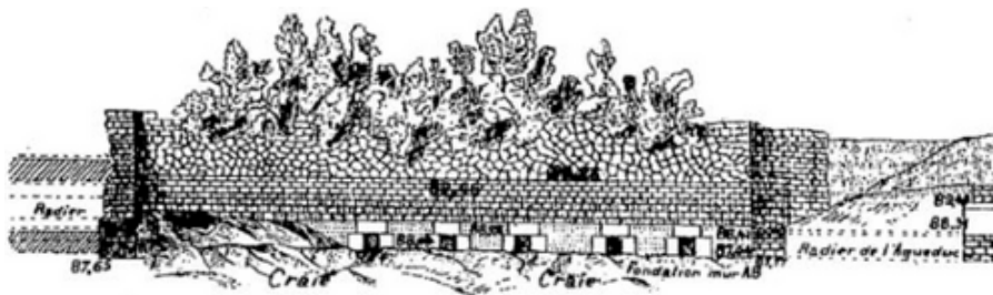
Fig. 59. — Aqueduc de Sens. Bassin de captage de la source de Noé.
