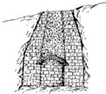
Fig. 106. — Four à chaux sommaire, à feu intermittent.
