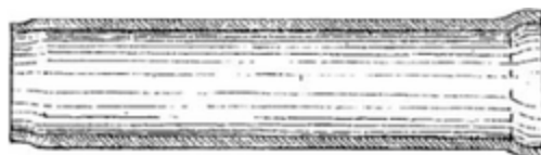
Fig. 80. — Joint à emboîtement.
