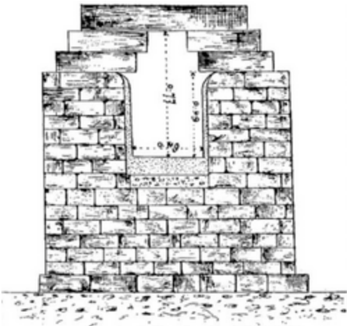
Fig. 1 — Section de l'aqueduc d'après Flacheron. venait d'ouvrir pour
