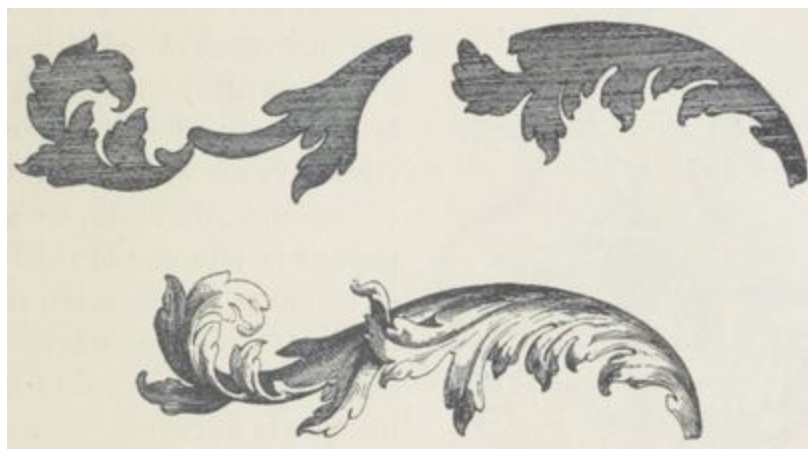
Fig. 74 et 75. — Feuillage d'ornement en tôle découpée, puis relevée et assemblée.
