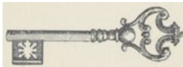
Fig. 96. — Clef é tampée et reprise à la lime et au ciselet.
