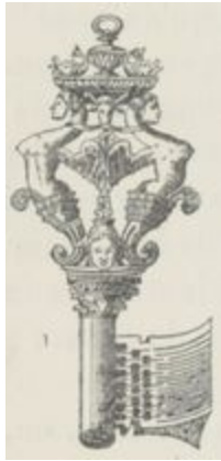
Fig. 21. — Clef ancienne brasée au-dessous de l'anneau.
