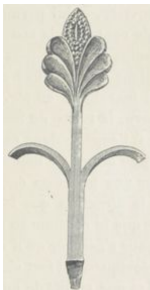
Fig. 32. — Fleuron achevé et prêt à être soudé.
