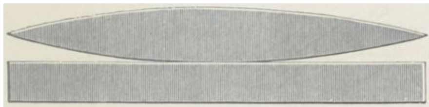
Fig. 2. — Couche d'air comprimée entre une lentille et un plan de verre. — Les vis de pression ne sont pas figurées.
