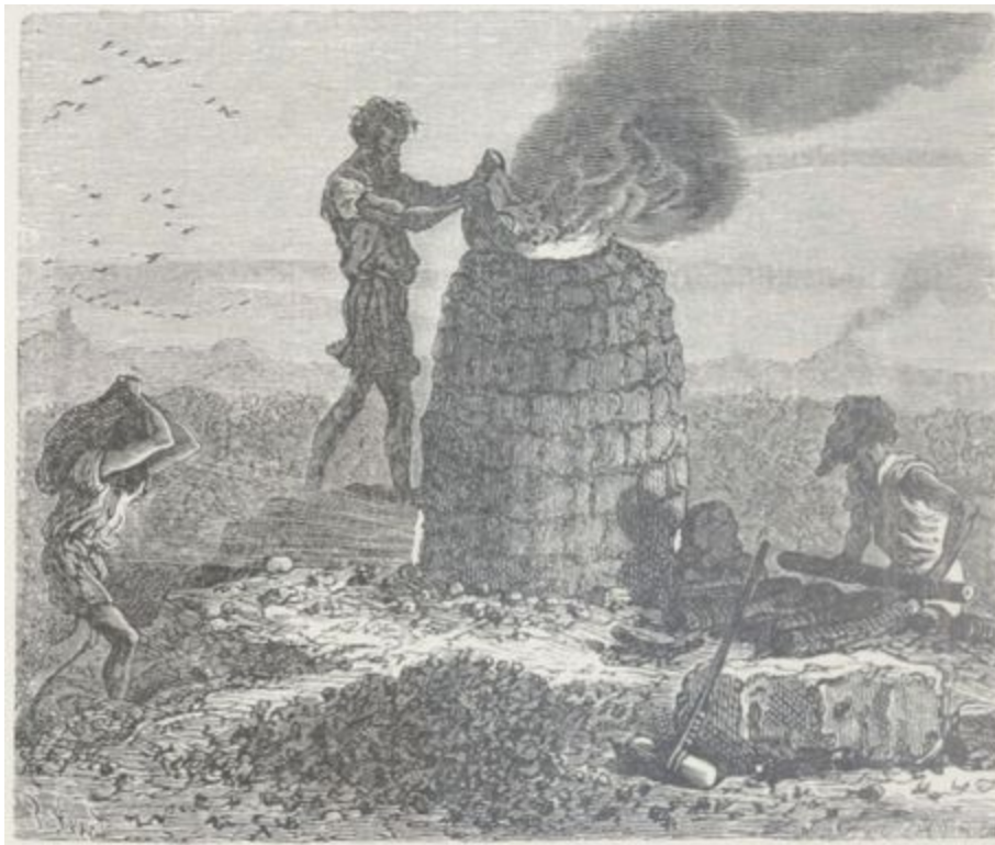
Fourneau à orientation des forgers primitifs.
