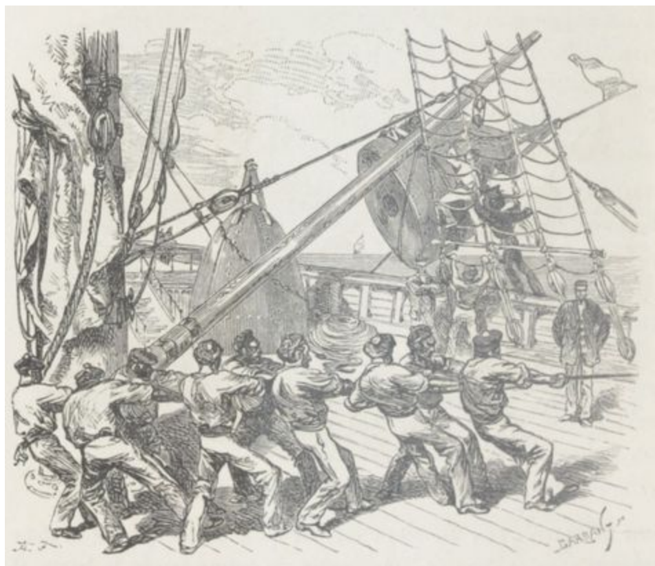
Fig. 124. — Descente de la bouée du câble.
