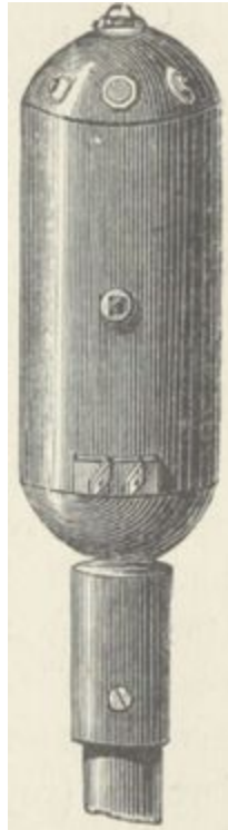
Fig. 42. — Ram torpedo de bateau-cigare.
