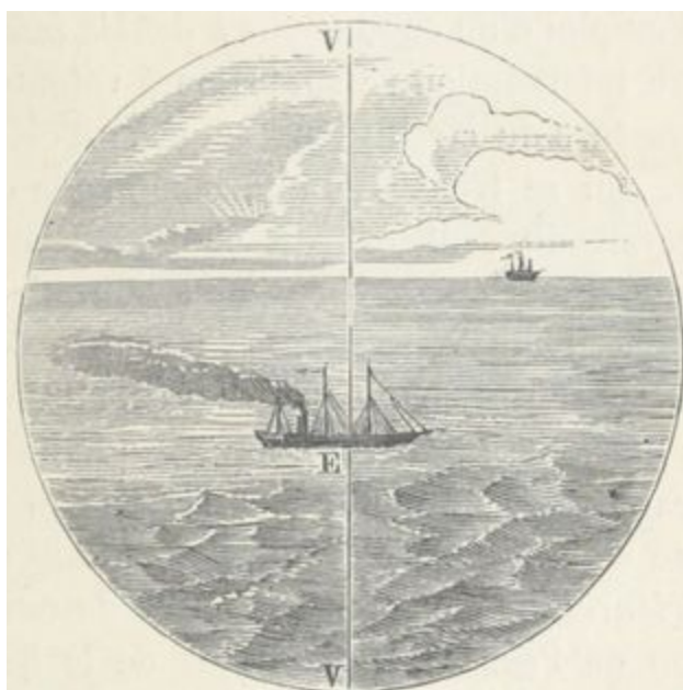
Fig. 12. — Mise du feu obtenue par le moyen d'une simple visée. VV, fil métallique croisant le champ du télescope et donnant l'alignement du mouillage E d'une torpille.
