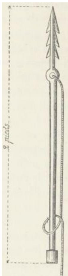
Fig. 63. — Harpon à torpilles hors de son espingole.
