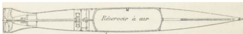
Fig. 55. — Torpille-poisson américaine (American torpedo fish).
