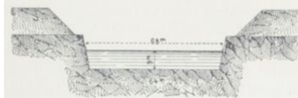
Fig. 15. — Gare du canal interocéanique dans les roches.
