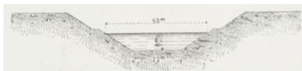
Fig. 12. — Profil du canal interocéanique dans les terres.
