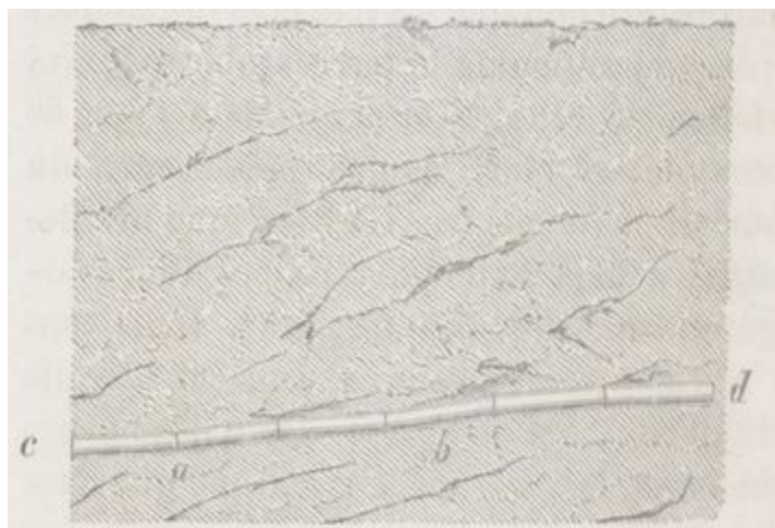
Fig. 226. — Tuyaux sinueux facilitant les dépôts calcaires ou ferrugineux.
