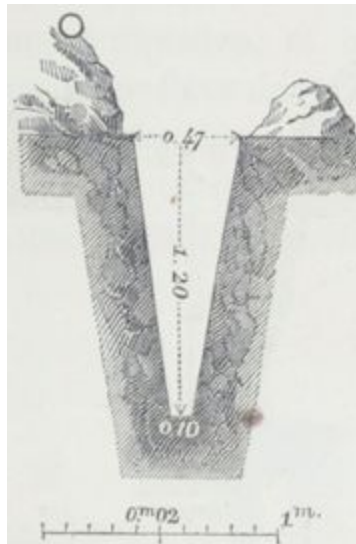
Fig. 130. — Tranchée moyenne pour les terrains argileux.
