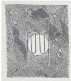
Fig. 190. — Fil de fer recourbé pour griller l'ouverture des drains.
