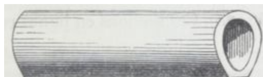
Fig. 23. — Gros tuyau ayant une base plane.
