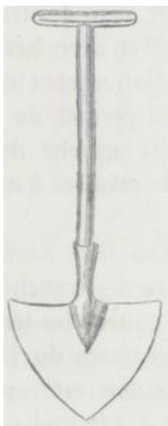
Fig. 133. — Bêche en forme de langue de bœuf pour tracer la direction des tranchées.
