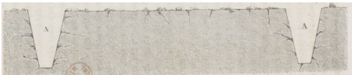
Fig. 233. — Assainissement incomplet du sol dans un drainage à fossés découverts.
