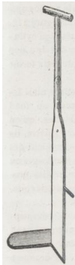
Fig. 211. — Louchet dit mèche de fer pour enlever les tranchées des drains moulés.
