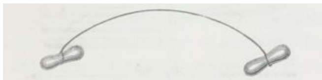
Fig. 69. — Fil de laiton pour couper la terre
