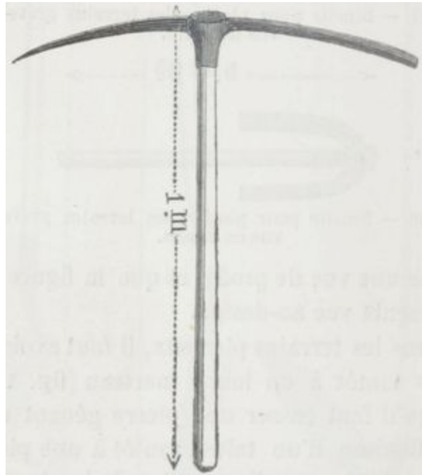
Fig. 150. — Pioche pour la fouille des tranchées.
