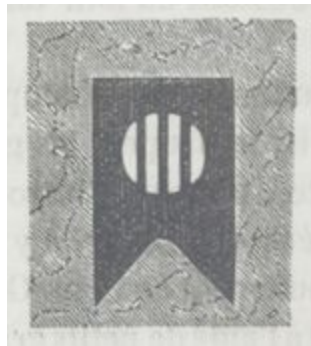
Fig. 191. — Plaque de tôle pour griller l'ouverture des drains.
