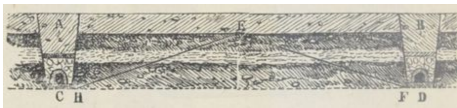
FIG. 8. — Effets du drainage sur la terre arable.
