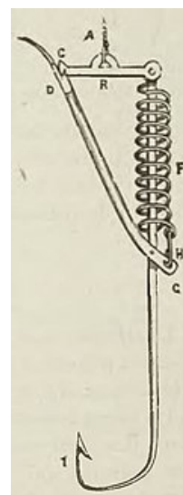
FIG. 93. — Hameçon Flamm, à ressort et à pince, pour la pêche de mer.
