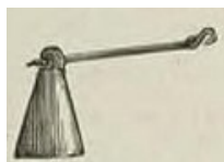
FIG. 133. — Plombée à anse de florence et à coulant.
