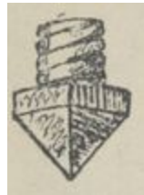
Fig. 122. — Crampon à vis du comte du Charo lais (Thary).
