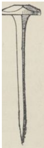
Fig. 80. — Clou à tête plate.
