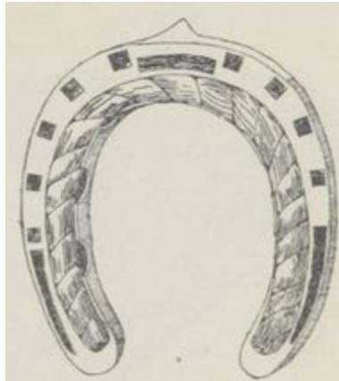
Fig. 106. — Fer antidérapant Idéal avec garniture câble.
