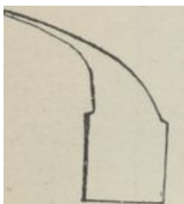
Fig. 116. — Clou rivé (Delpérier).
