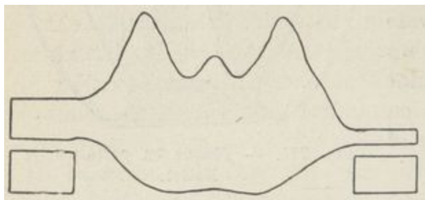
Fig. 223. — Patin rectificateur d'aplomb Tasset.
