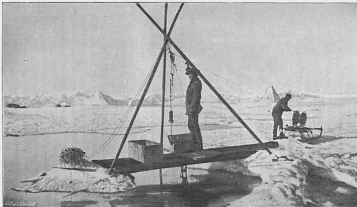
UN SONDAGE THERMOMÉTRIQUE A GRANDE PROFONDEUR—L'ARRIVÉE DU THERMOMÈTRE PLONGEUR (12 JUILLET 1894)
